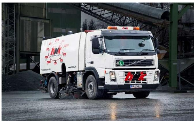
KEHRMASCHINE mit HECKABSAUGUNG
